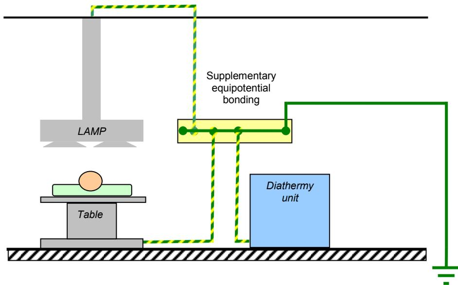
Figure 4. Equipotential bonding
